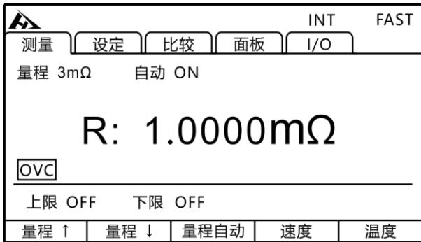
根据流过测量电流时的测量值 $R_P$ 与未流过测量电流时的测量值 $R_Z$ , 将 $R_P-R_Z$  显示为真电阻值。
