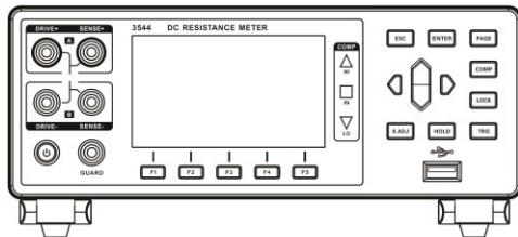
处于待机状态时，面板电源按键灯为红色，长按面板电源键，电源开启，屏幕点亮，面板按键灯变成绿色。
