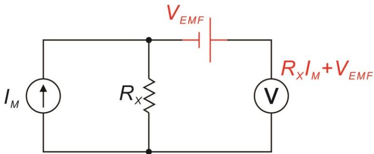
$V_{EMF}$ : 是热电势, 任何金属接触时候, 都会产生电势, 电势大小和温度有关。
