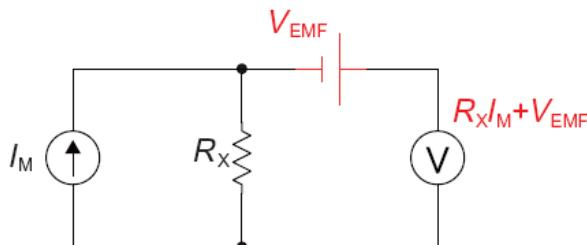
**V<sub>EMF</sub>**: 热电势，任何金属接触时候，都会产生电势，电势大小和温度有关。
