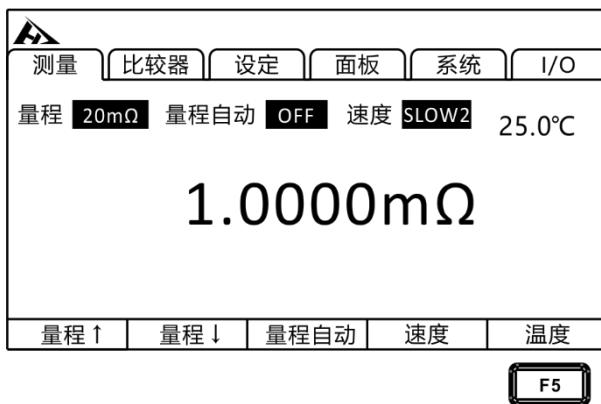
未连接温度探头，不能进行温度测量。未使用 TC 或  $\Delta T$  时，无需连接温度探头。不想显示温度时，请切换显示。
